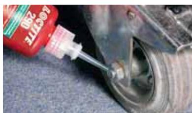
Mit normalen Handwerkzeugen nur sehr schwer demontierbar, eventuelles Erwärmen erforderlich. Für Schrauben in montierten Teilen, an Mess- und Regelgeräten, Vergaserschrauben.
