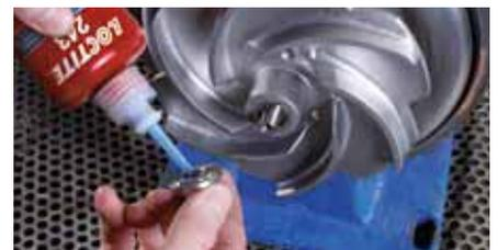
Mit normalen Handwerkzeugen aber schwieriger demontierbar, ideal für Befestigungsschrauben an Werkzeugmaschinen, Pressen, Pumpen, Kompressoren und Getrieben; für Gewinde bis M 80.
